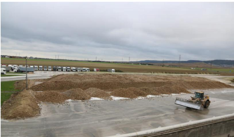
Pesées automatiquement, **stockées en un tas de 5500 t, transportées hydrauliquement**, lavées, découpées en cossettes, les racines de betteraves passent dans le diffuseur à contresens d'une eau chaude afin de récupérer le précieux jus sucré.
